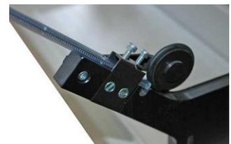
Der Vorschub erfolgt durch das Vorschubrad am Zubringer. Der gefederte Hebel sorgt dafür, dass keine weiteren Bauteile nachrutschen.
