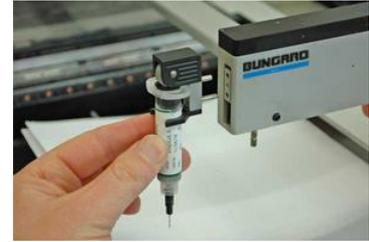
2. Zum Dosieren Kartuschenadapter durch Drücken des Knopfes am Bestückkopf absenken.
