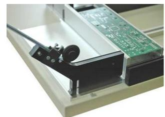
Fixieren der Stange im Zubringer durch die Befestigungsschrauben
