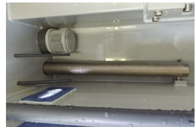
Heizung, Filter und Sensoren
